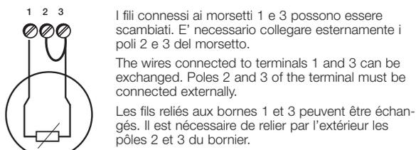
4. Schema di collegamento ingresso ausiliario • Auxiliary input connection diagram
