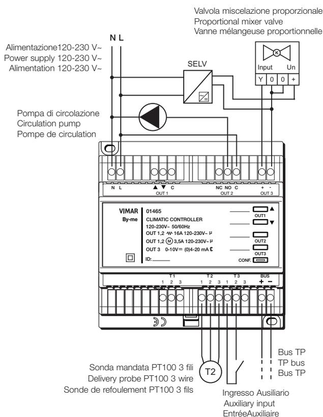
**Nota:** Al regolatore climatico è sempre necessario connettere la sonda di mandata (T2); la sonda esterna (T1) è invece necessaria nella modalità di lavoro modulante quando la temperatura esterna è impostata come locale.
