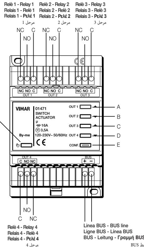
A: Led e Pulsante attuazione relè 1 - LED and button to actuate relay 1
